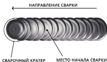
Рис. 12.4. Начало сварки при смене электрода.
